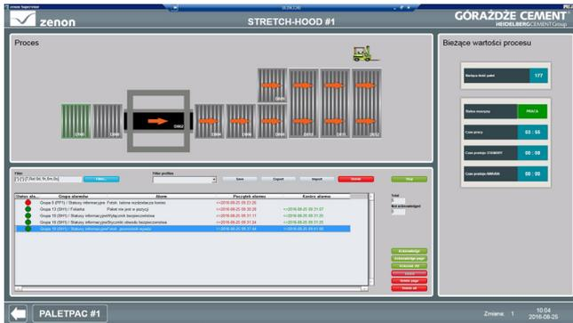
Überwachung grundlegender Parameter: Prozessschritte, Alarme und aktuelle Maschinendaten.
