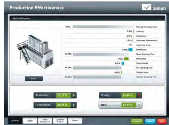
Abbildung 4: zenon ermöglicht die Berechnung und Anzeige der Echtzeit-Performance-Indikatoren ohne Programmierung, nur durch Parametrierung.
