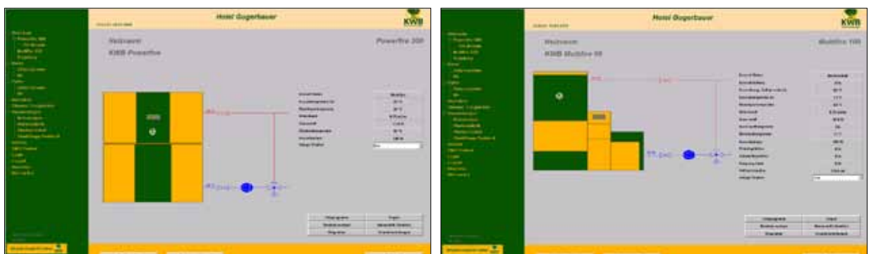
Alle relevanten Werte aus dem Heizhaus, direkt visualisiert im Hotel und jederzeit abrufbar: links die Einstellungen des KWB Powerfire 300 kW Brenners, rechts die Einstellungen des KWB Multifire 100 kW Brenners.
