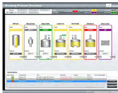
Abbildung 2: Visualisierung und Steuerung von Prozessen beim Bierbrauen mit zenon.
